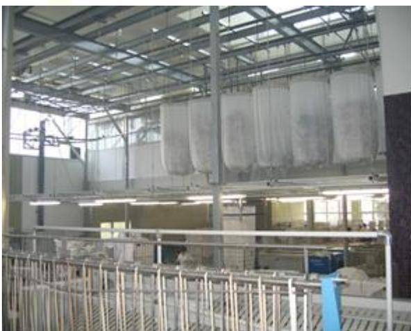
Mit der Errichtung der Trockenwäsche Förder- und Speicheranlage konnten die Prozessabläufe optimiert werden. Weiter konnte die Sicherheit in der Produktionshalle erhöht werden, da die Wäsche nun in Säcken in der Höhe und nicht am Boden in Wäscherollcontainer gelagert wird. Eine Überfüllung der Wäscherollcontainer wird vermieden, wodurch keine Wäschestücke zu Boden fallen können.
