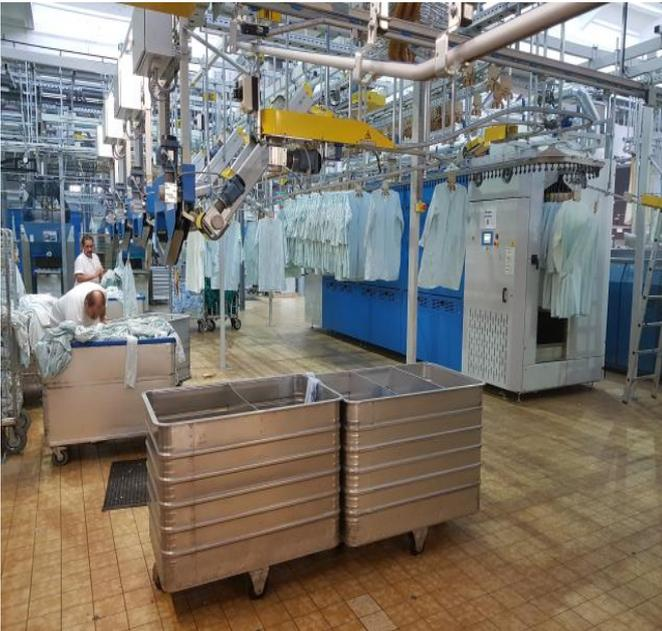
Zwischenzeitlich wurden in der SWR alle Finisher erneuert. Die neuen Finisher arbeiten mit wesentlich weniger Energieaufwand und höheren Stückzahlen pro Stunde. Mit dieser Finisheranlage die vorwiegend für die Fertigung von Patientenhemden geplant ist konnte eine weitere unabhängige Produktionsanlage bei den Finishern errichtet werden. Zur besseren Auslastung des Finishers wurde 2018 ein zweiter Faltröbter angeschafft.
