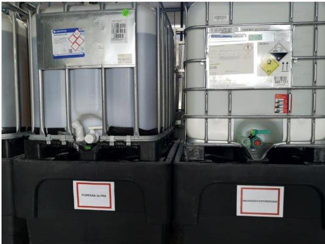
Im Normalbetrieb treten bei uns keinerlei Emissionen in den Boden auf. Um das Risiko einer Bodenverunreinigung z.B. durch Auslaufen oder Verschütten von Reinigern zu minimieren, wurden unter anderem, folgende Vorbeugemaßnahmen getroffen:
